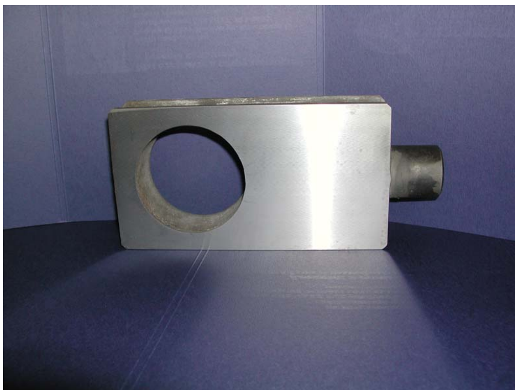
Рис. 2 Шиберная задвижка. Восстановлена и упрочнена рабочая поверхность.
