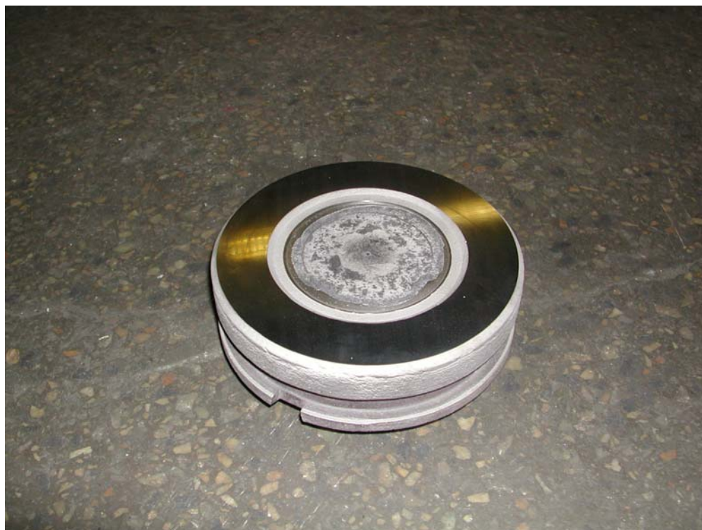
Рис. 3 Шибер клиновой задвижки. Восстановлена рабочая поверхность
