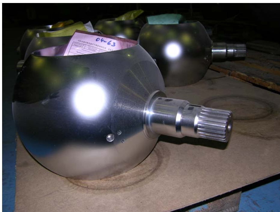
Рис.6 Шаровой кран. Восстановлена шаровая поверхность.
