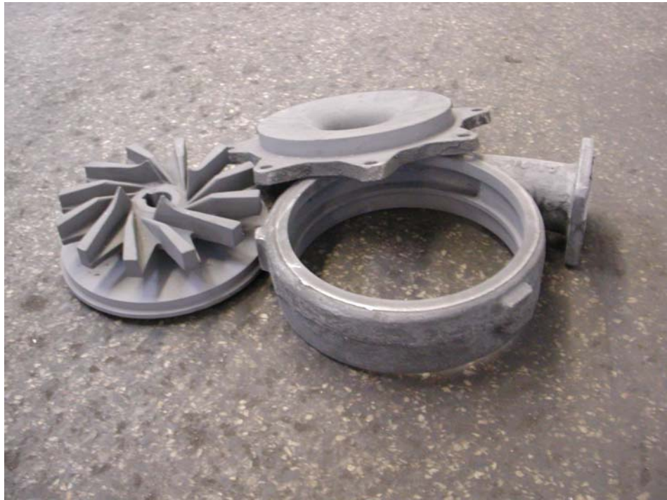
Рис. 4 Детали насоса. Нанесено упрочняющее покрытие.
