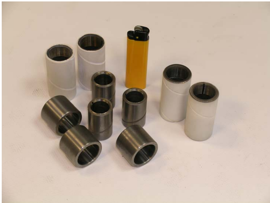
Рис.5 Подшипник скольжения. Нанесено композиционное металлополимерное покрытие
