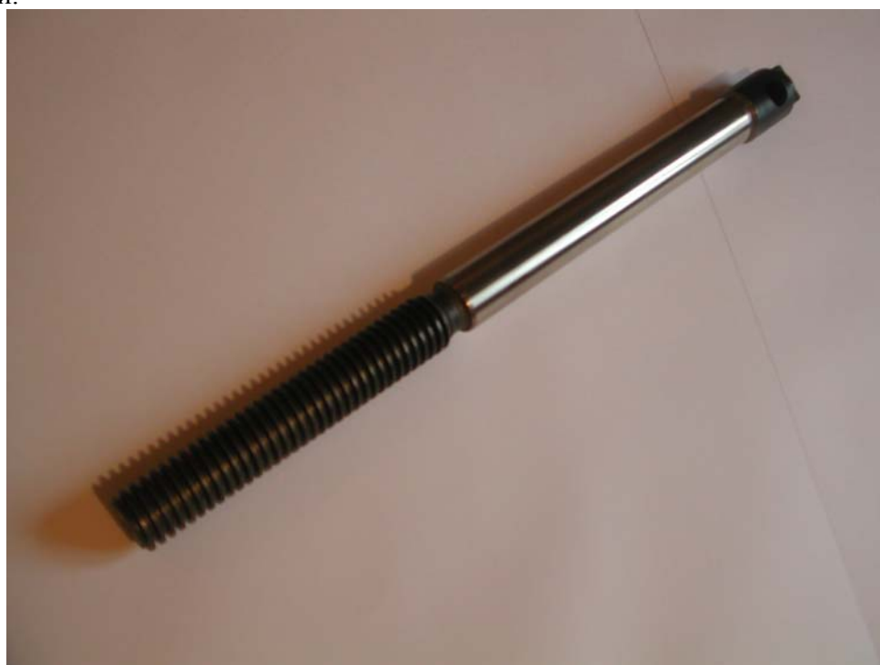
Рис. 1 Шток запорной арматуры. Восстановлена рабочая поверхность.
